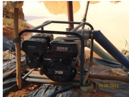
รูปที่ 2-14 ปั๊มน้ำบริเวณบ่อรับน้ำ (Sump) ภายในพื้นที่โครงการฯ
